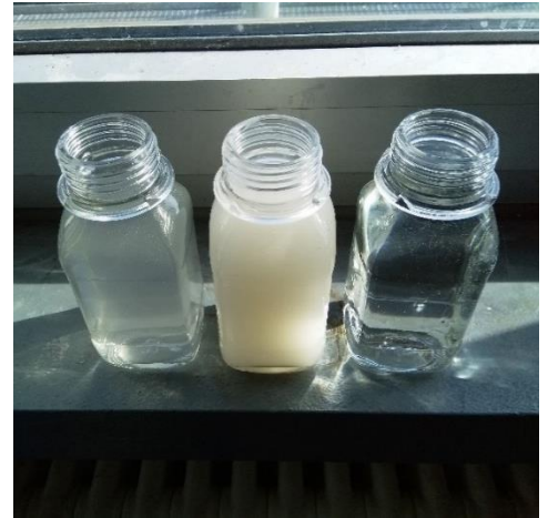
Links: verschmutztes Bad Mitte: erzeugtes Konzentrat (=Abwasser) Rechts: erzeugtes glasklares Filtrat
