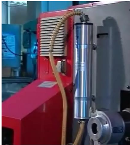
Zwischen Kühlmittelpumpe und Werkzeug zu montieren
